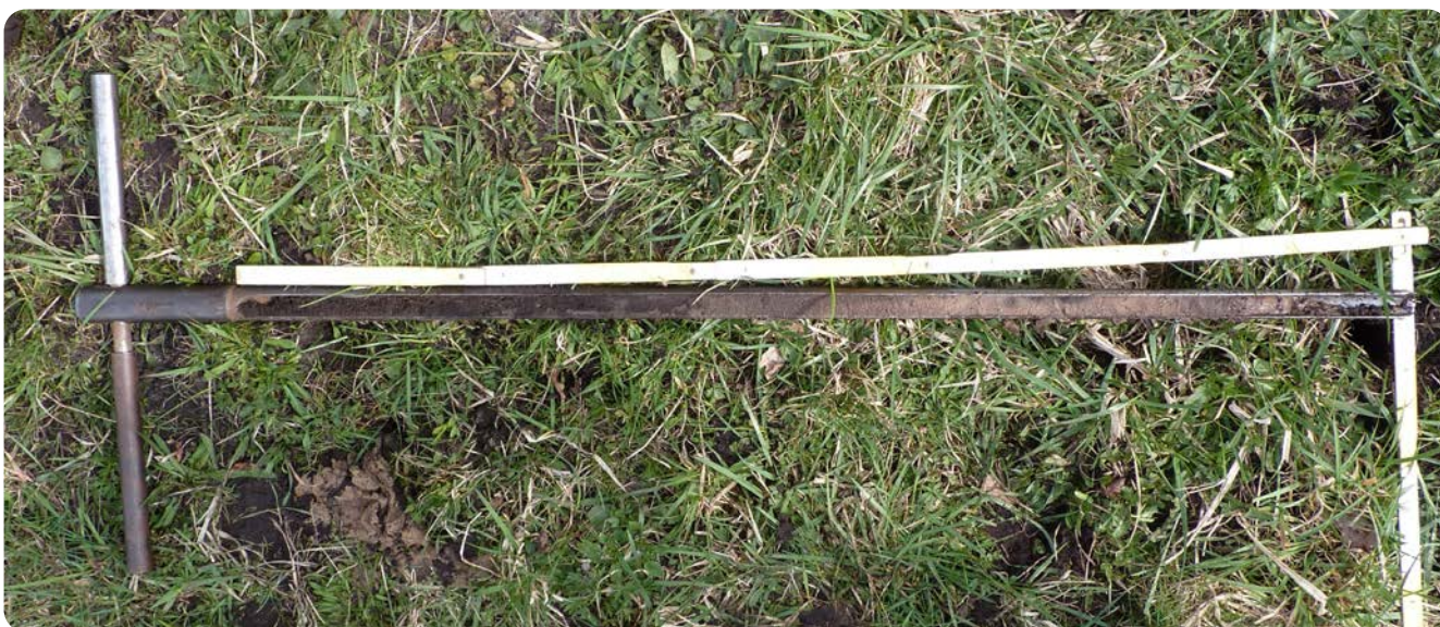
Abb. 35: Pürckhauer (Hohlmeißelbohrer) für Bodenuntersuchung, Foto: SupapleX
