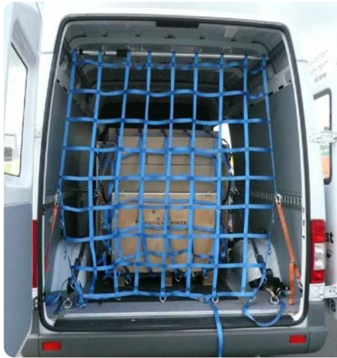
Abb. 62: Netze zur Ladungssicherung, Foto: A. Krieger
